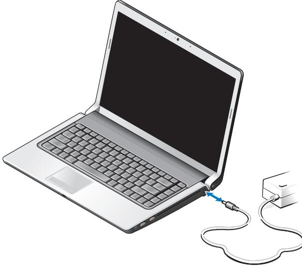
**تنبيه:** يعمل محوّل التيار المتردد مع مأخذ التيار الكهربائي في جميع أنحاء العالم. إلا أن موصلات الطاقة ووحدات مشترك الكهرباء تختلف من بلد إلى آخرى. ويؤدي استخدام كبل غير متوافق أو توصيل الكبل بشكل غير سليم في مشترك الكهرباء أو المأخذ الكهربائي إلى نشوب حريق أو إتلاف المعدات.
